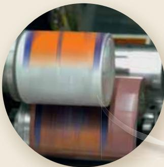
Der Motiv-Siebdruck erfolgt auf ein Trägerpapier, das Dekorbild wird auf den Becherkörper übertragen.
